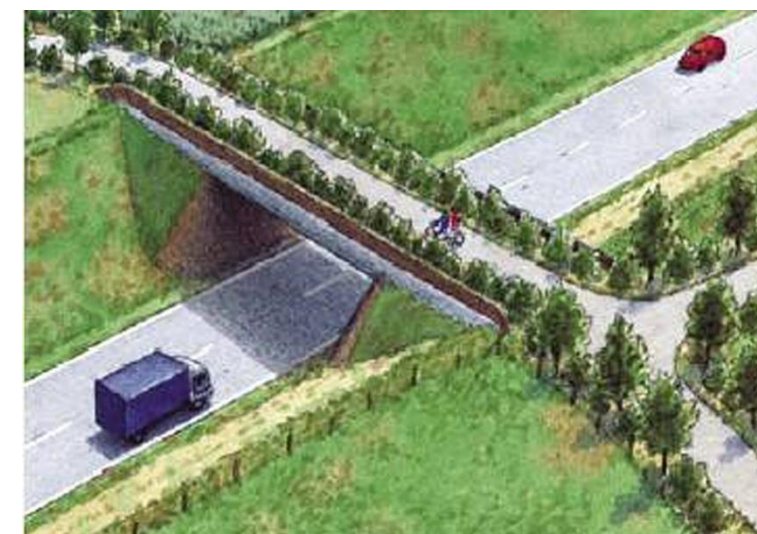
Figure 37: Un pont planté de linéaires de buissons peut guider les chauves-souris à traverser une voie routière ou ferroviaire (d'après Limpens H.J.G.A., P. Twisk P. & G. Veenbaas, 2005)
