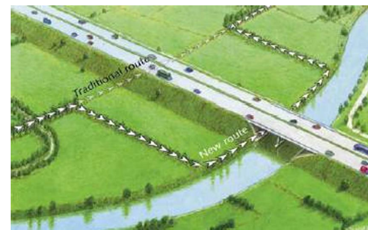
Figure 37: Un pont planté de linéaires de buissons peut guider les chauves-souris à traverser une voie routière ou ferroviaire (d'après Limpens H.J.G.A., P. Twisk P. & G. Veenbaas, 2005)
