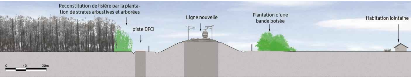
Figure 105: Coupe de principe pour la traversée et la coupure des airiaux (Source : Egis, 2013)
