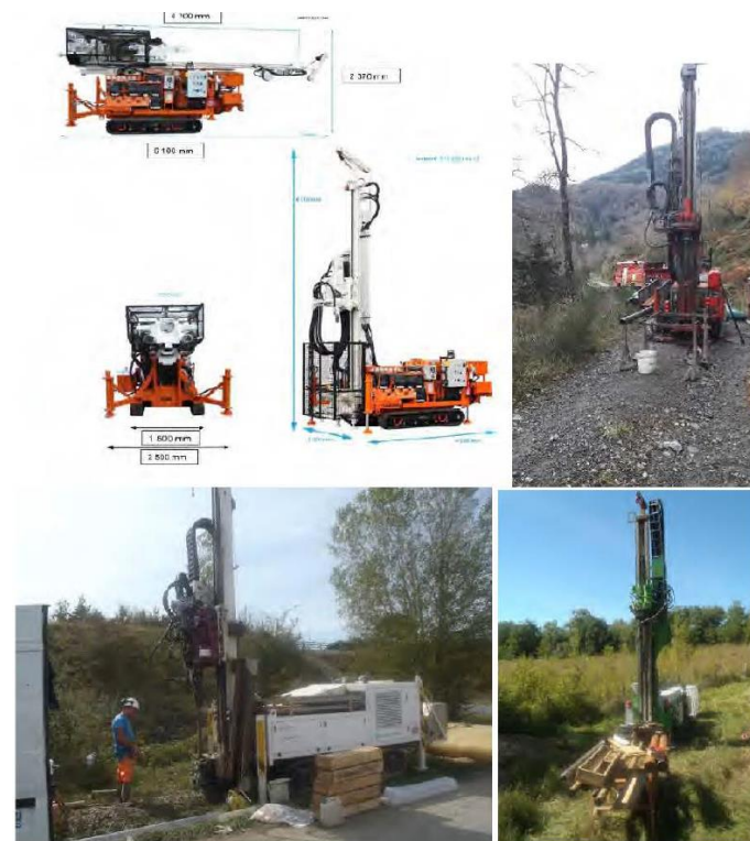
Figure 3 : Exemple de machine d'essai de pénétration statique (Source : SNCF Réseau)
