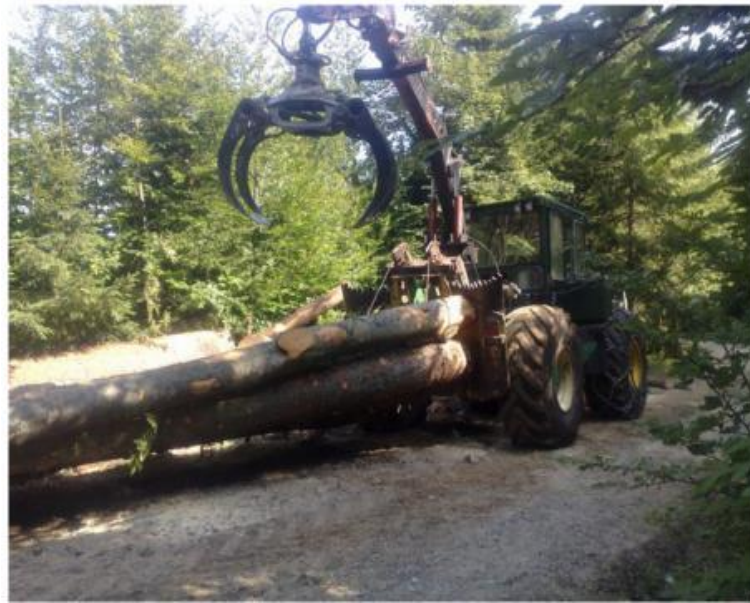
Figure 6: Débardage et débusquage (Source : SNCF Réseau)
